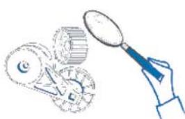
**4** Substitua os rolamentos de apoio e tensores que apresentarem desgaste.
